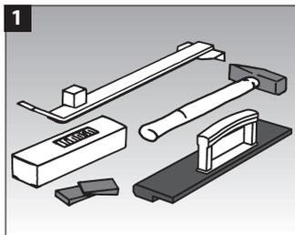
**1** Verlegewerkzeug: Schlagklotz, Abstandskeile, Montageeisen, Hammer (mindestens 800 g), Bleistift; zum Absägen genügt eine einfache Handsäge.
